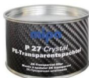
Masilla de alto poder de relleno, diseñada para superficies de carbono. Ahorra tiempo en la igualación de superficies de distintas capas. Resistente a los UV. Lijable a las 2 horas con P220 agua - P360 seco.
